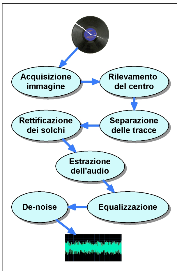
Figura 3. Schema a blocchi del sistema di acquisizione.
