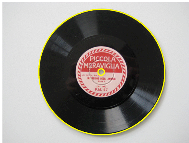
Figura 2. rilevamento automatico dei contorni del disco e del foro centrale. In questo caso, la deviazione tra i centri delle due circonferenze è di 0.22 cm.
