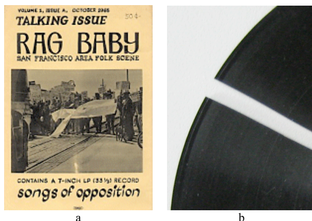
Figura 7. Fotografia della busta originale (a) e del disco rotto (b).
